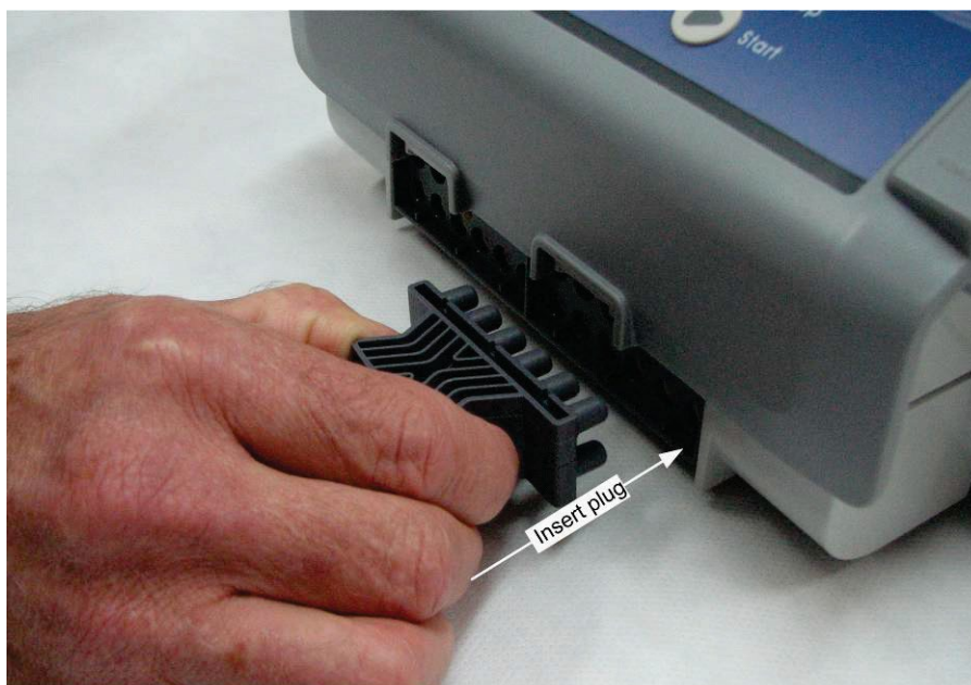
Figur 7 – Sätta i stor blindpropp
