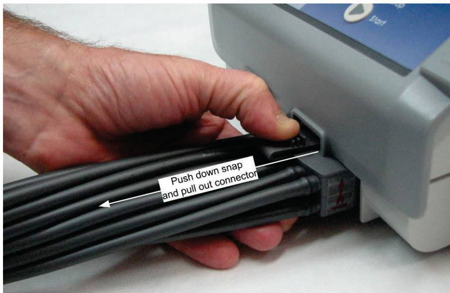
Figur 9 – Koppla bort slangbunten
